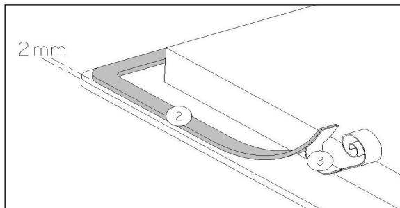
Fäst tätningslisten (2) två millimeter från glasetts ytterkant, efter att Du avlägsnat det skyddande pappershölet (3).
