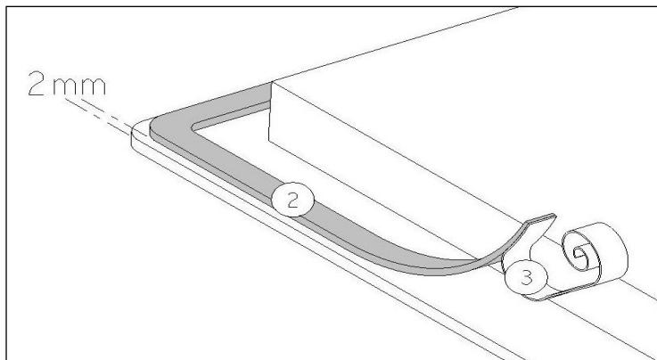
Fastgør tætningslisten (2) to millimeter fra glasses yderkant – efter De har fjernet den beskyttende papiroverflade (3)
