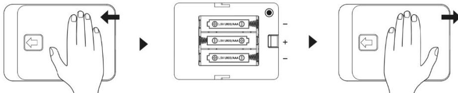
Ouvrez le cache-piles en le faisant coulisser dans le sens de la flèche.
