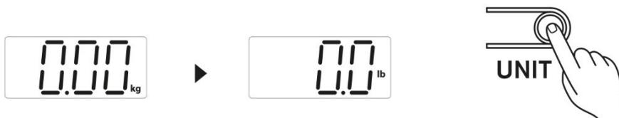
Appuyez sur le bouton « Unit » situé à l'arrière du pèse-personne pour sélectionner l'unité de mesure de poids.
